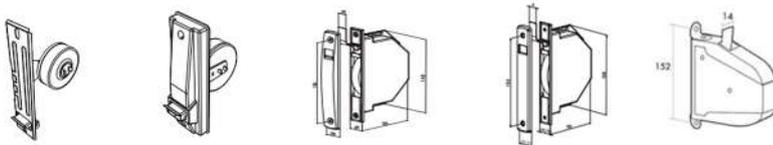
CAPSULAS CONTERAS ESPIGA O RODAMIENTO ( EJE DE 40, 50 O 60)
